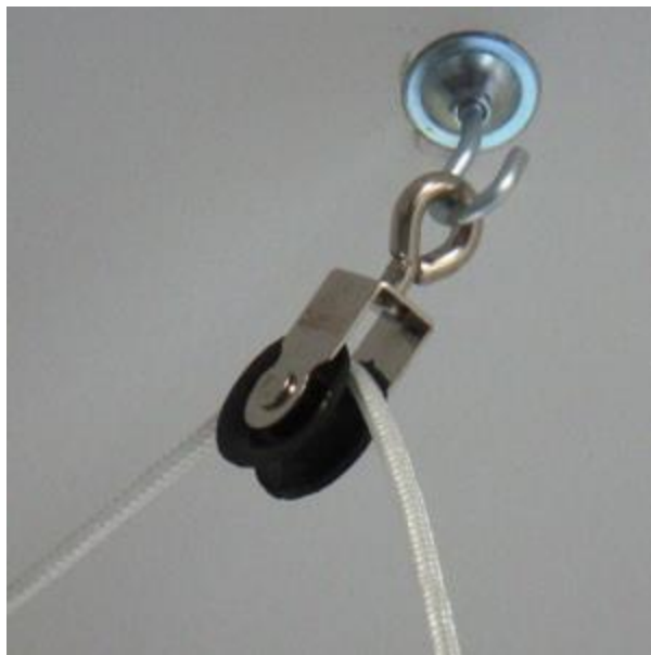
Soga de un tendadero colgante Ábaco pasando por una roldana del techo
